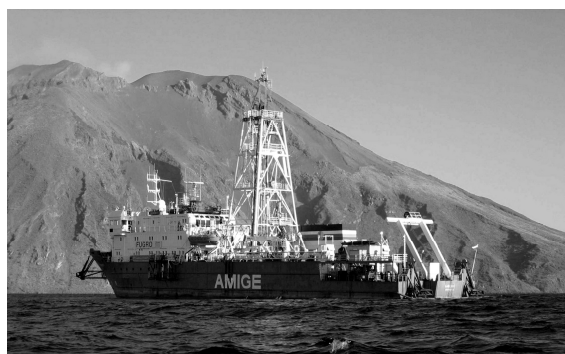
Figura 4.1. Vaixell perforador SRV Bavenit emprat en les perforacions i assajos del Golf de Lleó i la Mar Adriàtica dins el projecte PROMESS 1. Al fons s'observa l'illa de Stromboli.
