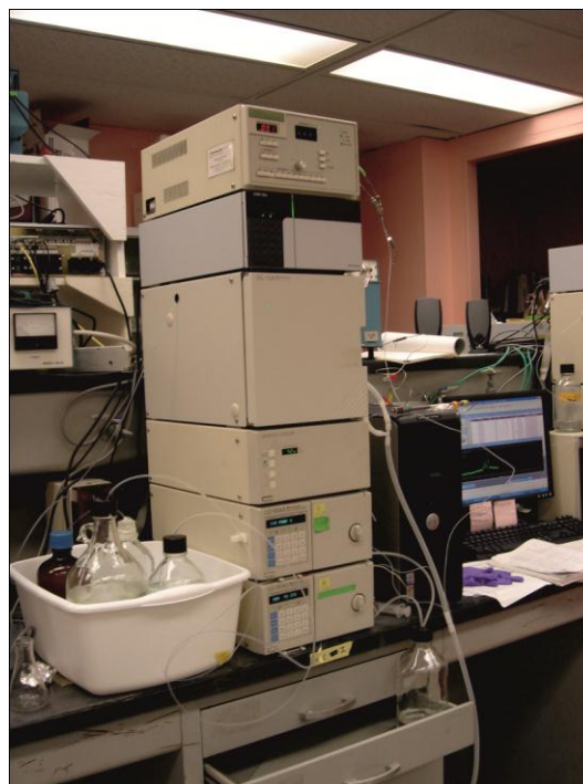
Fig. 1.8 Fotografia del HPLC amb el detector de fluorescència per analitzar el contingut de pigments en l'extracte de les mostres. Laboratori de química orgànica (Pink-Lab) de la Dra. Cindy Lee (Universitat d'Stony Brook, Nova York).
