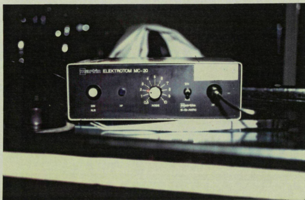
Figura 35: Aparato de coagulación bipolar. Las pinzas están en primer plano.
