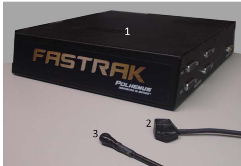
Fig. 28. Fastrak™ Polhemus (1), transmisor (2) y receptor (3) .
