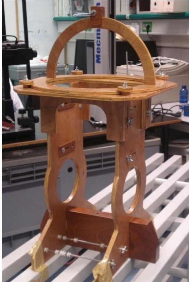
Fig. 27. Soporte para la pieza anatómica utilizado para este estudio.
