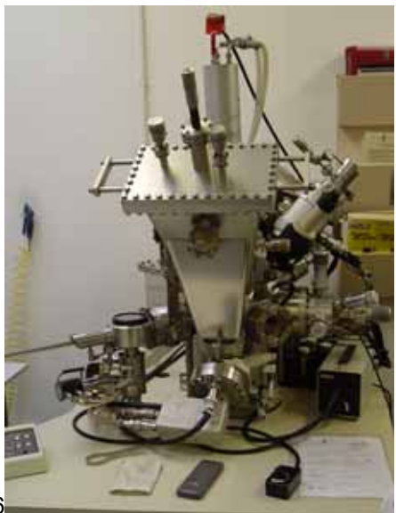
Fig.26. Equipo de Espectrometría Esca-XP. Fig.27. Monitor con los resultados numéricos y gráficos.
