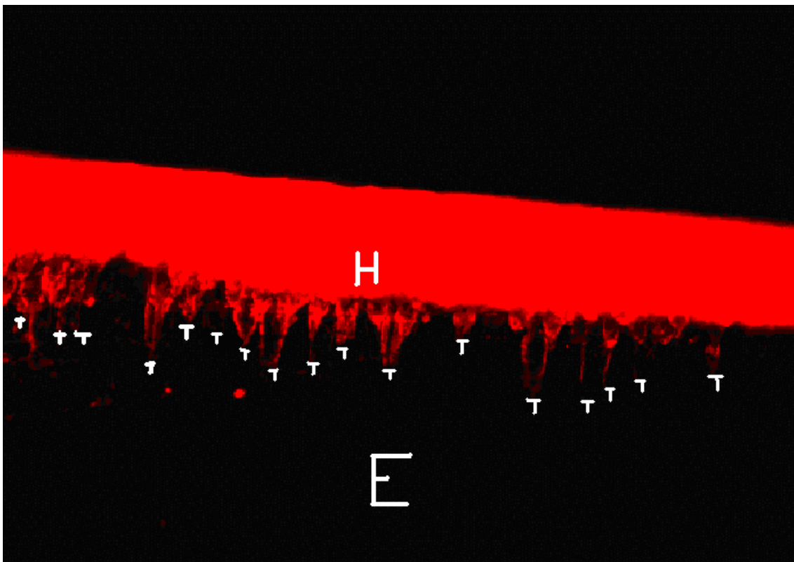
Fig. 41. Imagen de microscopia confocal por fluorescencia tratada con Metamorph Analysis Software UIC TM de muestra del grupo 1. Donde capa híbrida (H), “tags” (T) y esmalte (E).
