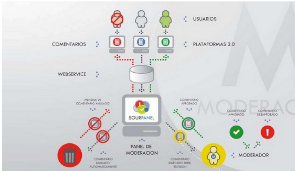
Figura 17: Diagrama donde se muestra el funcionamiento del sistema y como los contenidos se descartan o se admiten.
