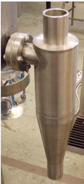
Figura 7-8 .- Ciclón colector del producto final.
