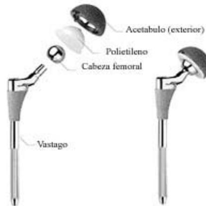
**Figura 1-1: Ejemplo de una prótesis de cadera con un par articular metal-PE [8]**
