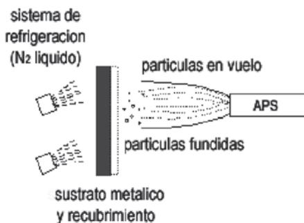
Figura 2. Esquema del sistema de proyección.
