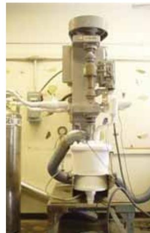
Figure 3.1. Cryomilling attritor.
