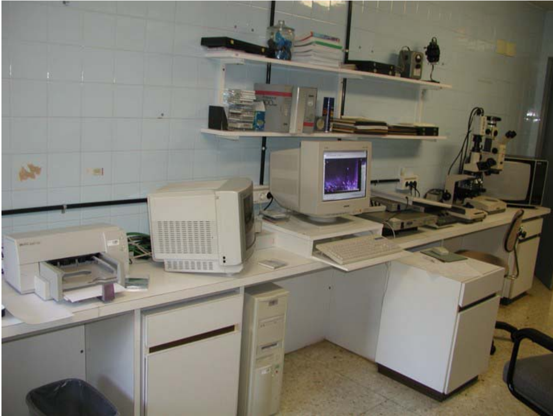
Figura 13. Microscopi òptic amb càmera de video connectada a l'ordinador.
