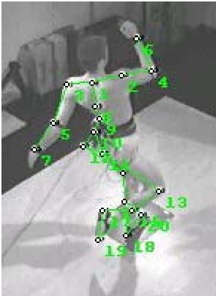
Fig. 19.- Distribución de los puntos articulares mediante reflectores ópticos
