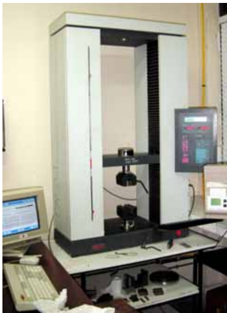
Figura 22: máquina de ensayos de tracción-compresión Adamel Lomargy ® modelo DY34 , equipada con una célula de carga de 10KN y conectada a un PC con software Autotrac ® .
