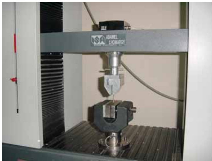
Figura 31: detalle de las garzas de la máquina donde ya se ha colocado una muestra de tejido cicatricial a estudio.
