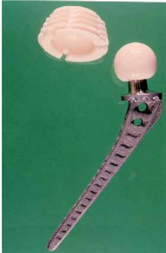
Figura 1.5.- El tercer modelo de componente femoral (Mark III) muestra una superficie porosa por la presencia de pequeñas bolitas metálicas sinterizadas sobre un vástago del tipo Mark III.
