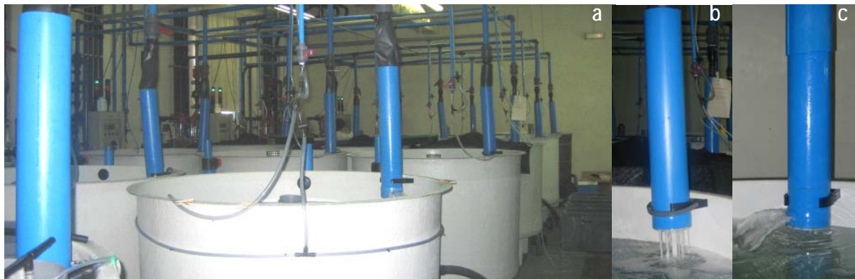
Figura 56. Instal·lacions experimentals del Centre d'Aqüicultura de Sant Carles de la Ràpita (a); fluxe normal d'entrada d'aigua (b); fluxe incrementat d'entrada d'aigua (c).
