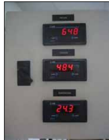
Figura 1.19. Comandament control que ens mostra en tot moment els valors de pressió (hPa), temperatura ( ^{\circ}C ) i humitat relativa (%), que hi ha a l'interior de la cambra.
