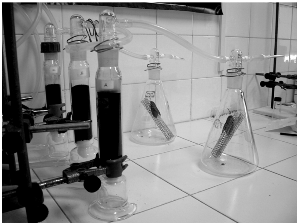
Figura 6. 8. Montaje utilizado para la extracción de volátiles.
