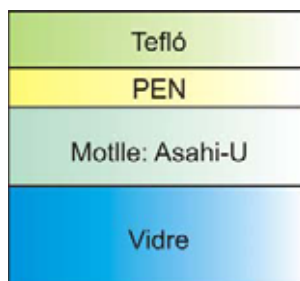
Figura 3.10. Col·locació d'una làmina de tefló (gruix \sim 1 \text{ mm} ) sobre l'estructura motlle-PEN per distribuir d'una manera més homogènia la pressió aplicada sobre seu.
