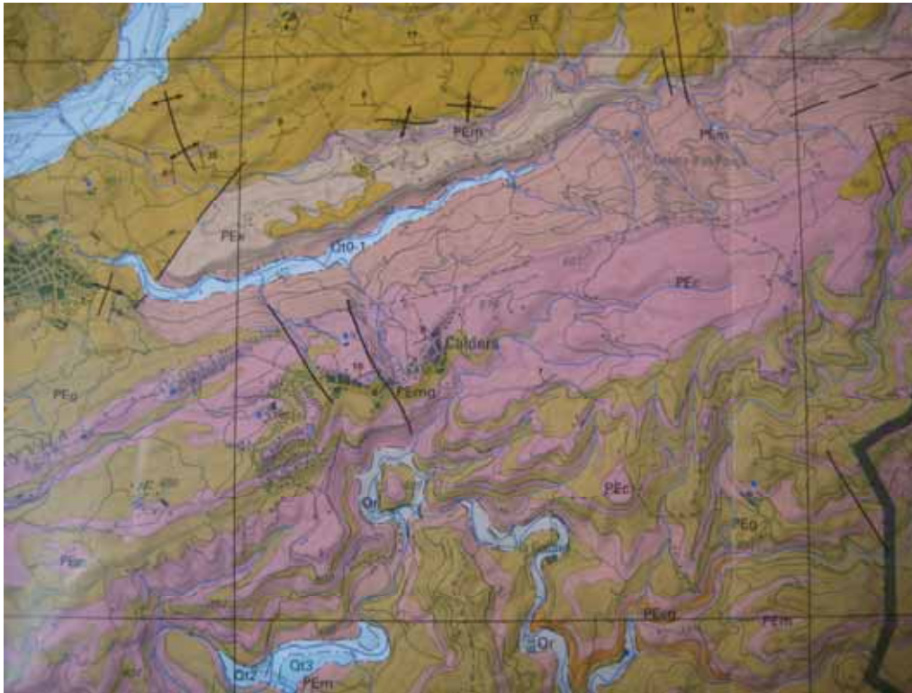
Mapa n. II. 3. Fragment del mapa geològic comarcal de Catalunya: BAGES, a escala 1/50.000. Els materials dominants corresponen al Paleogen, Eocè, dins del Cenozoic.
