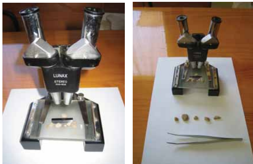
Fotos n. II. 23 Lupa binocular Lunax Stereo 50/30X, emprada pel reconeixement de mostres al gabinet
