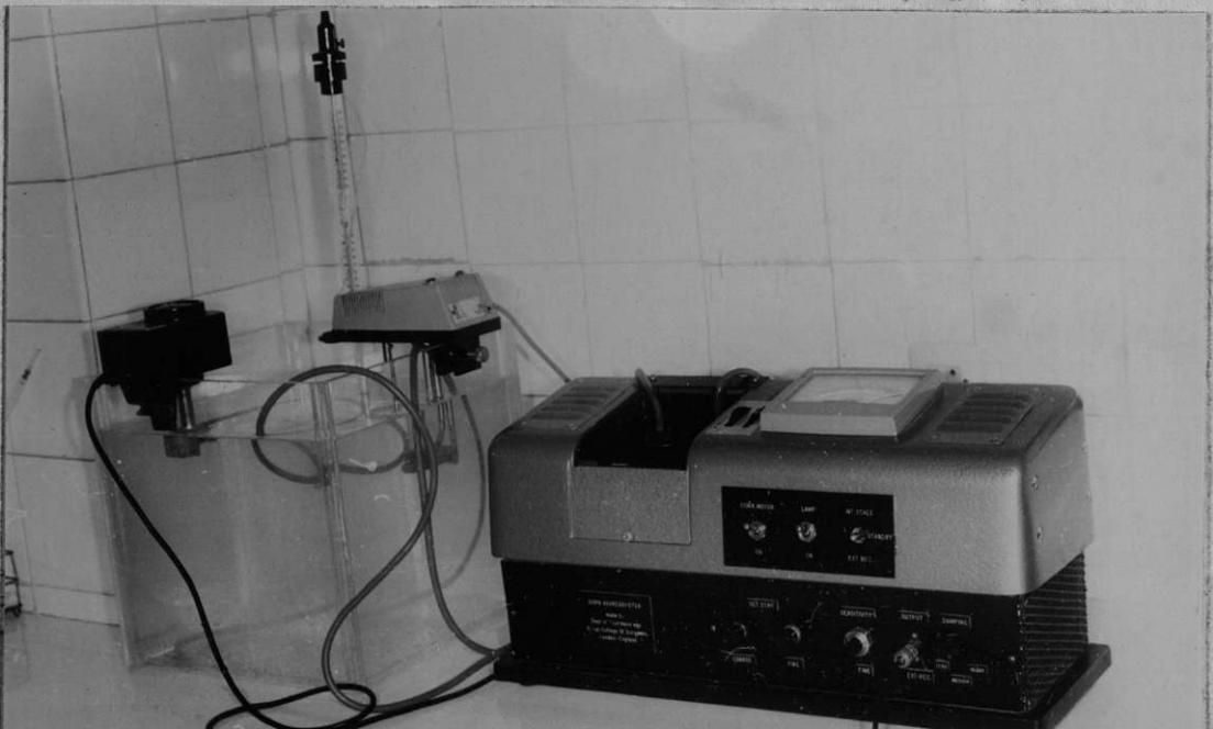
Con este aparato se dispone de un mando para poner en marcha un mecanismo magnético que agita un pequeño cilindro de hierro recubierto de plástico que añadimos a cada tubo; este agitador, se mantuvo constante a 500 r.p.m. y además nos ha servido de guía para obtener el punto correcto de iniciación de la agregación.
