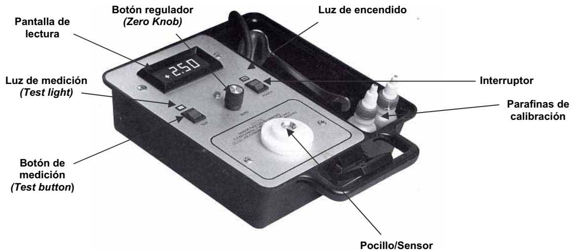
Figura 33. Esquema del instrumento FOS NI-21B utilizado en la determinación de la constante dieléctrica.
