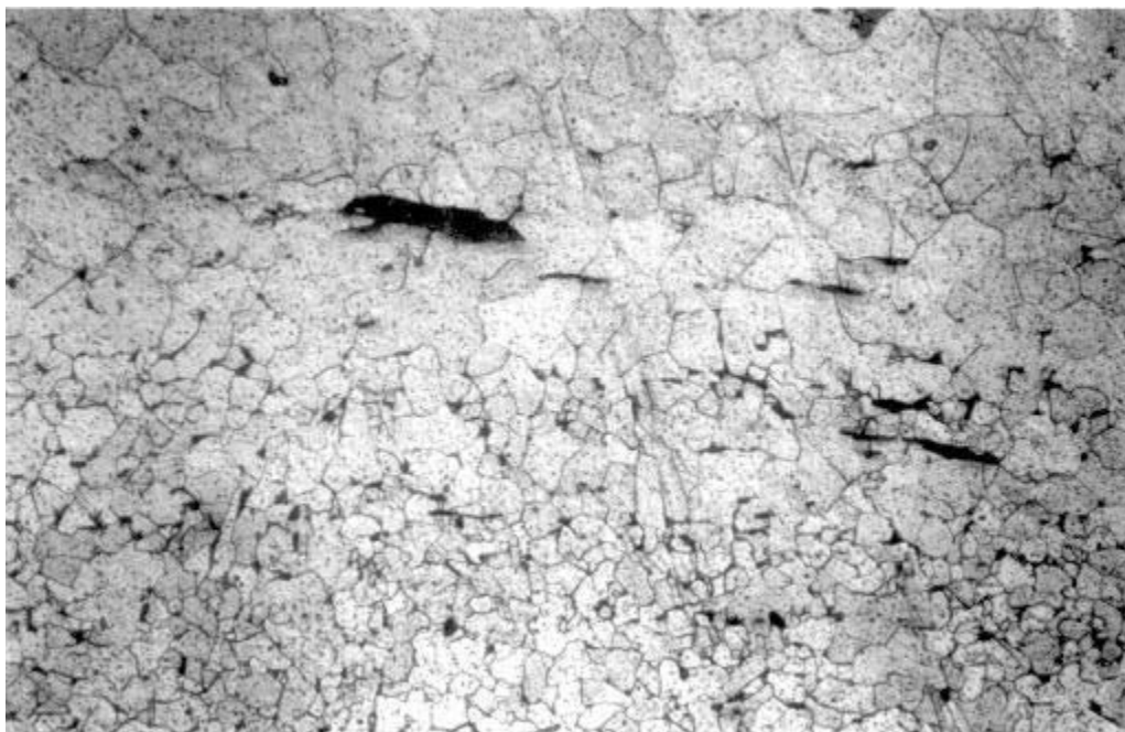
PT/2060/1. Fotografia 1. Microestructura ferrítica amb grans de diferents grandària i morfologia (x 180 augm.).
