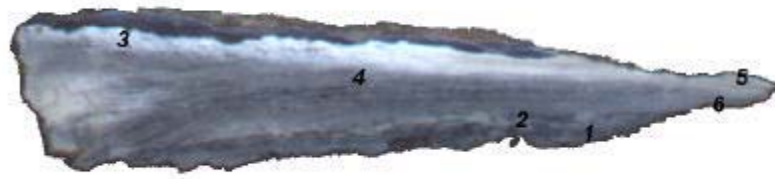
Figura 5. Localització de microdureses sobre PT/2061/1 ( 1. 102 HV; 2. 98 HV; 3. 96 HV; 4. 148 HV; 5. 165 HV; 6. 106 HV).
