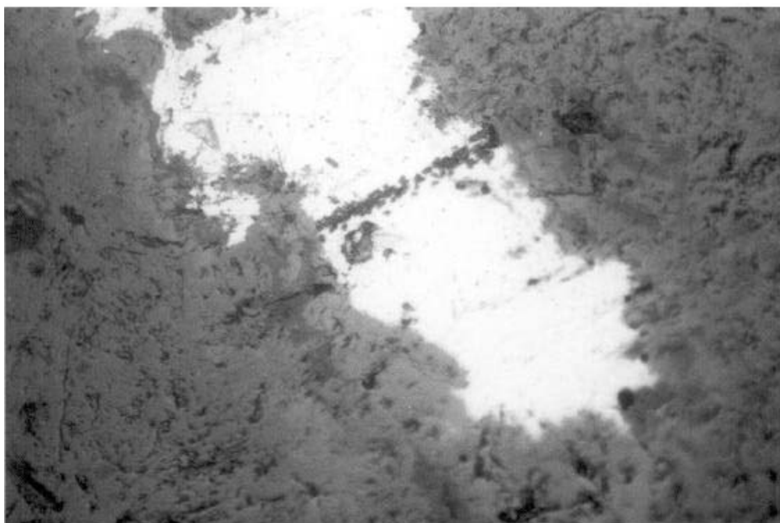
PT/2007/1. Fotografia 1. Partícula de ferro, molt possiblement colònia de grans ferrítics, enmig de la matriu oxidada amb empremtes de carburs (x 225 augm.).
