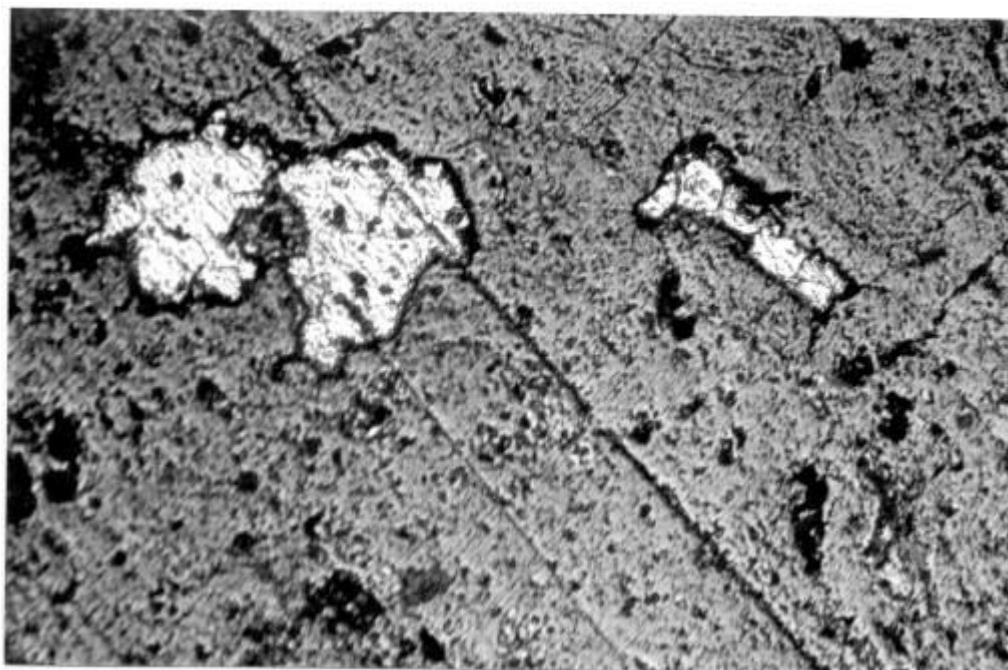
PT/2021/1. Fotografia 1. Colònia de grans ferrítics sobre la matriu oxidada de la mostra (x 225 augm.).
