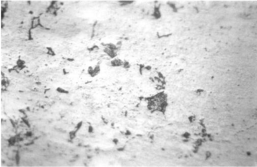
PT/2044/2. Fotografia 1. Relíquies de grans perlítics i de cadenes de cementita lliure impreses sobre la matriu d'òxid (x 360 augm.).
