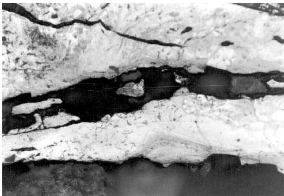
PT/2008/1. Fotografia 1. Escletxa interna amb algunes empremtes de cadenes cementítiques al seu perímetre (x 112 augm.).
