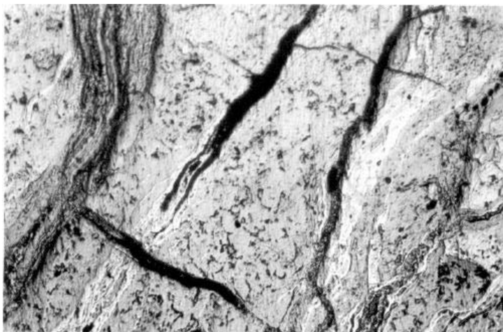
PT/2077/1. Fotografia 1. Imatge genèrica de les empremtes de cadenes cementítiques sobre la matriu oxidada (x 170 augm.).
