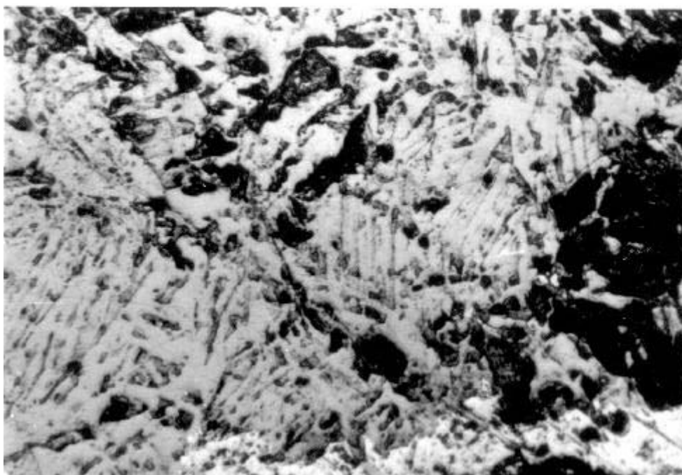
PT/2005/1. Fotografia 3. Imatge d'empremtes de possible microestructura de caràcter hipoeutectoide ja desapareguda (x 225 augm.).
