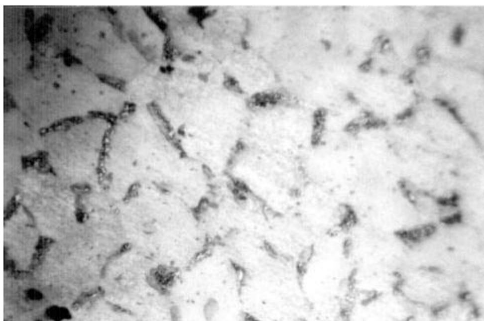
PT/2017/1. Fotografia 4. Disposició vermicular dels grans perlítics de la matriu ferríticoperlítica (x 560 augm.).
