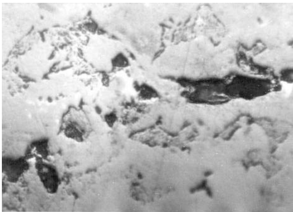
PT/2020/1. Fotografia 3. Detall de relíquies de grans perlítics i d'inclusions no metàl·liques (x 900 augm.).
