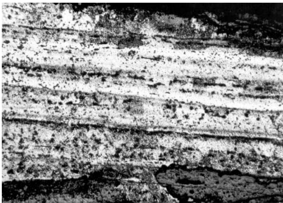
PT/2022/1. Fotografia 1. Imatge genèrica de la mostra amb les línies d'inclusions i microstructures de divers grau de carburació (x 125 augm.).
