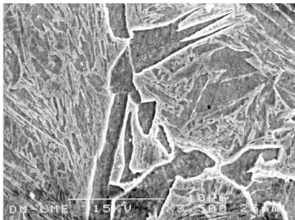
PT/2001/1. Fotografia 4. Microestructura amb colònies martensítiques (x 3500 augm.).
