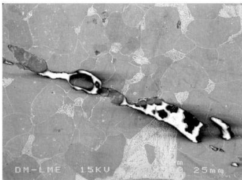
PT/2002/4. Fotografia 2. Imatge d'una inclusió no metàl·lica sobre la matriu ferriticoperlítica de la mostra (x 500 augm.).
