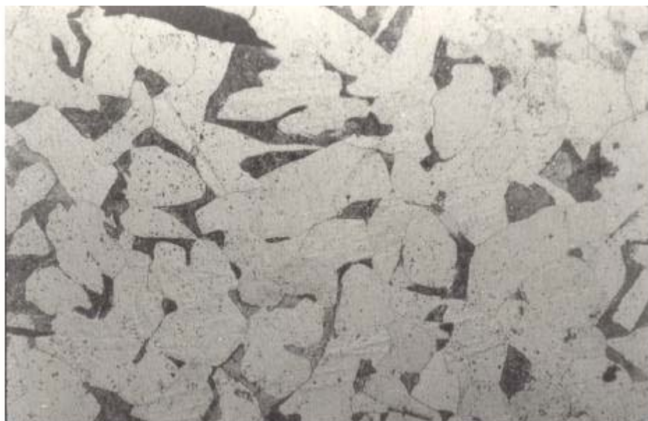
PT/2002/3. Fotografia 1. Microstructura de caràcter hipoeutectoide de baix contingut en carboni (x 225 augm.).
