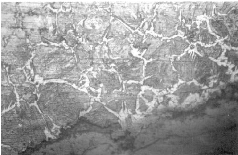
PT/2002/6. Fotografia 1. Microestructura ferríticoperlítica amb algunes agulles en disposició Widmanstätten (x 360 augm.).
