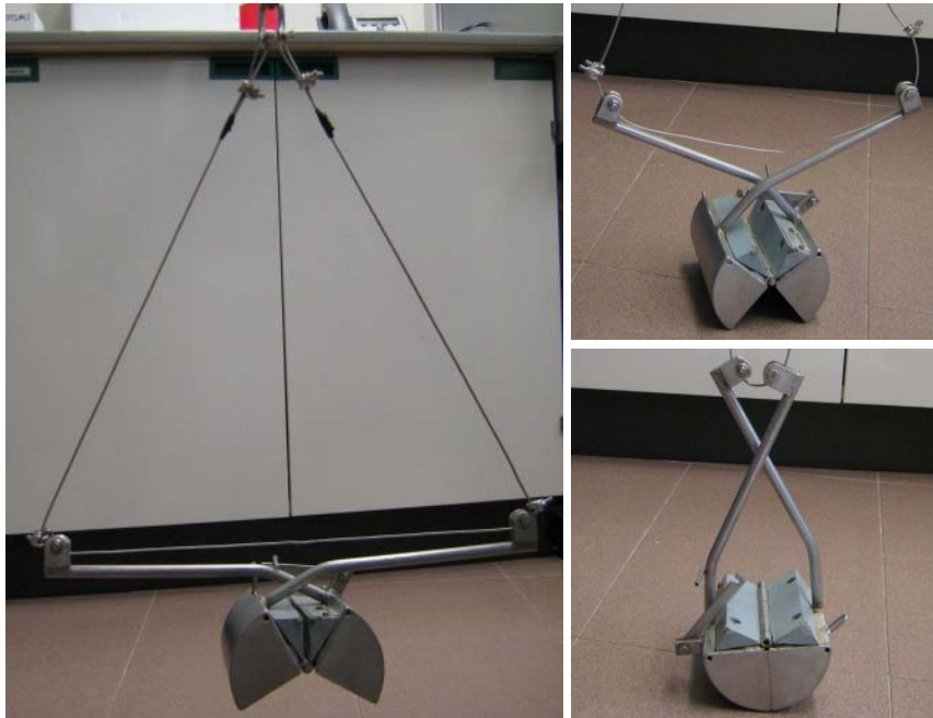
Figura 3.3: Draga Van Veen per sediments i detall del seu funcionament
