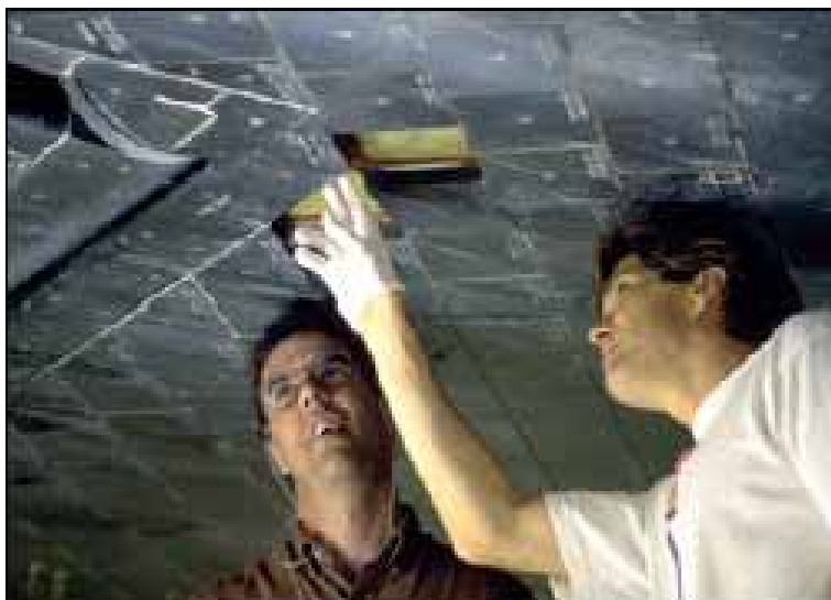
Figura 1.2: Revisión y sustitución de las cerámicas dañadas en el sistema de protección térmica del trasbordador.
