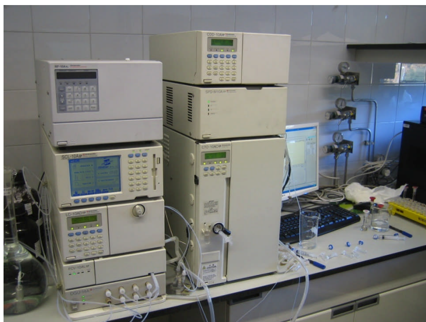
Figura 5.10. Equip de cromatografia líquida Shimadzu 10A VP . Dotat de detector de diodes en fila SPD-M10A VP i de conductivitat CDD 10A VP , permet l'anàlisi d'espècies aromàtiques i àcids carboxílics alifàtics per cromatografia líquida en fase inversa i d'exclusió iònica, respectivament, així com la detecció d'ions per cromatografia de bescanvi iònic.
