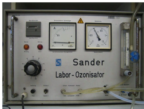
Figura 5.2. La mescla ozó/oxigen és generada per un ozonitzador de descàrrega a alta tensió Erwin Sander 300.5.
