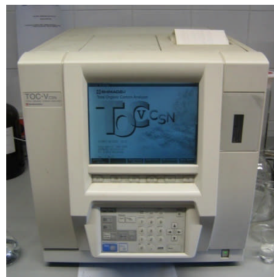
Figura 5.8. Analitzador de carboni orgànic total Shimadzu TOC V CSN .
