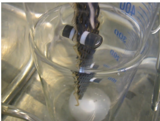
Figura 5.7. Fotografia de l'assemblatge de dos electrodes de BDD de 26,8 cm 2 amb una membrana de Nafion ® entre ells actuant com a electròlit polimèric sòlid. L'electròlit polimèric sòlid permet operar a potencials raonablement baixos sense la necessitat d'afegir una sal com a electròlit de fons a la dissolució tractada.
