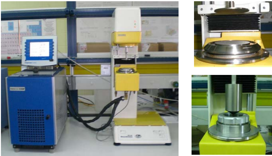
Figura 3.1. Reòmetre Haake RS80 i bany Haake C25P. A la dreta, detall dels dos sensors emprats.
