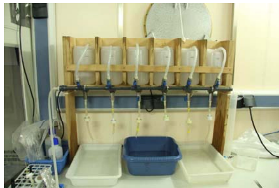
Figura 2.6. (a) Sistema de filtració per obtenir les mostres d'aigua per les anàlisis de paràmetres dissolts i (b) sistema de filtració per obtenir les mostres de filtres per les anàlisis de paràmetres particulats.
