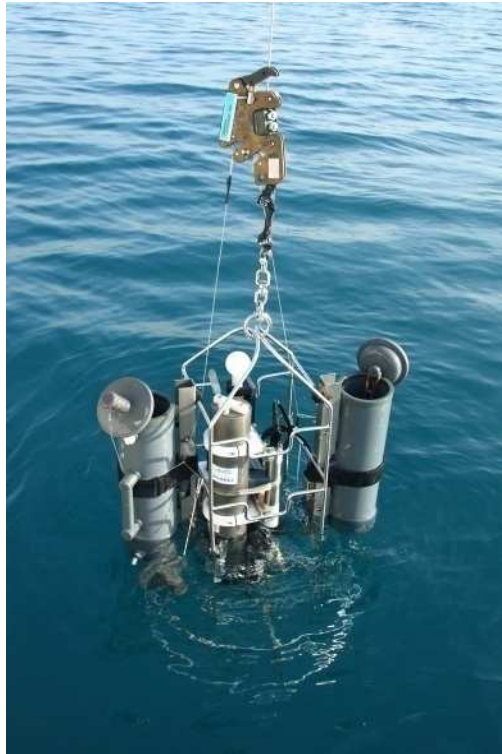
Figura 2.5. Muntatge del CTD amb les dues botelles Easy-Flow de 5L acoblades a l'estructura metàl·lica.
