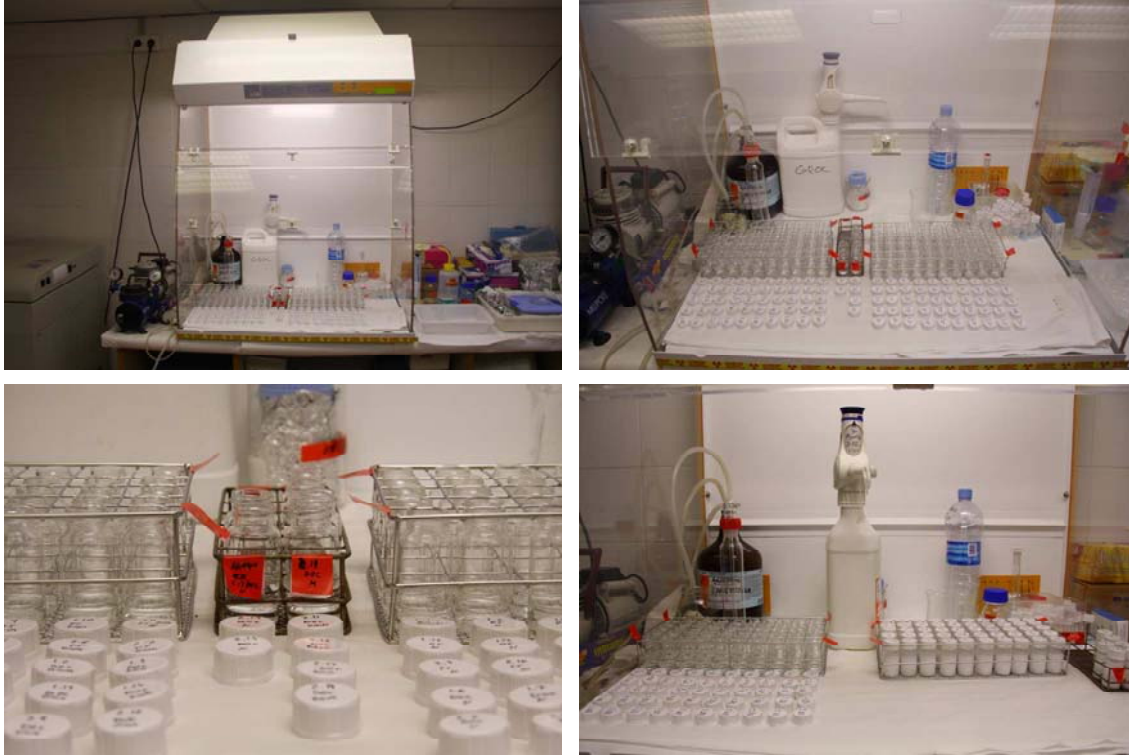
Figura 2.12. Mostres corresponents a PP_{COT} i PP_{COD} en vials de centelleig de 20ml sota una campana d'extracció en el moment d'alliberar el carboni inorgànic. En la fotografia inferior dreta es pot veure una part de les mostres a les que ja se'ls hi ha dispensat el líquid de centelleig. El volum de mostres que s'observa equival al generat en un únic mostreig i tenint en compte que hi manquen les mostres de PP_{COP} .
