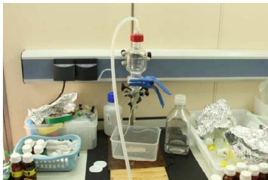
Figura 2.6. (a) Sistema de filtració per obtenir les mostres d'aigua per les anàlisis de paràmetres dissolts i (b) sistema de filtració per obtenir les mostres de filtres per les anàlisis de paràmetres particulats.
