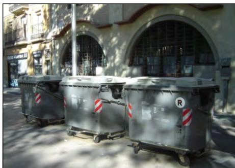
Contenedores orgánico 1.110Lts, base de mecanismo y rueda metálica, cuerpo de plástico. Dimensiones: Largo 1,36m, ancho 1,20m, alto 1,47m
