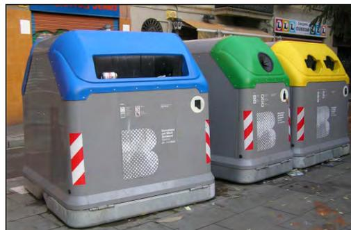
Contenedores de reciclaje, base metálica y cuerpo de plástico. Dimensiones: Largo 1,60m, ancho 1,50m, alto 1,80m
