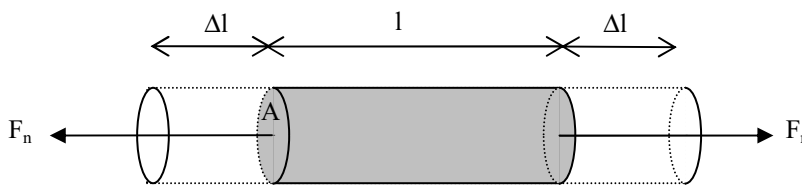
Fig.V.7 Representació esquemàtica del comportament d'un objecte a l'aplicació d'una força
