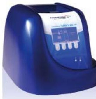
Figura 18. Equipo TurbiScan<sup>®</sup> LabR<sup>166</sup>
