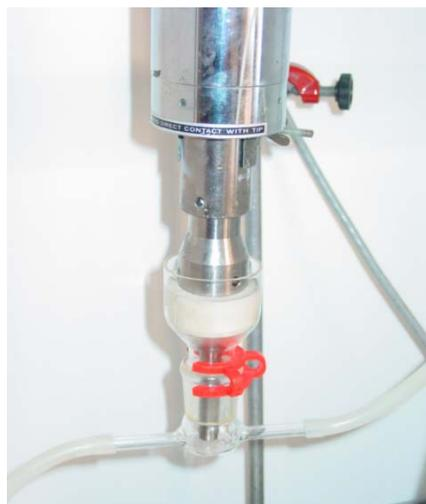
*Figura 27. Receptáculo de vidrio que contiene la sonda de ultrasonidos.*
