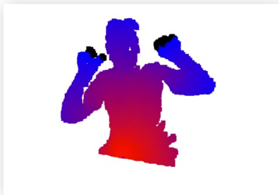
Figura 34: Las regiones en negro corresponden a las manos detectadas automáticamente por el sistema.
