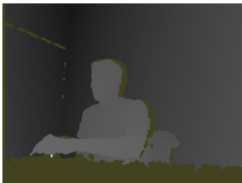
Figura 41a: Se muestra un ejemplo de los datos de entrada nuevos conteniendo únicamente la información de profundidad.
