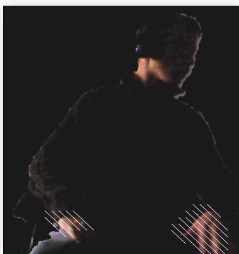
Figura 33: Muestra la detección de las regiones de mayor movimiento entre dos frames consecutivos pintadas con líneas diagonales blancas.
