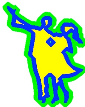
Figura 11: Ejemplo de erosión(en amarillo) y dilatación(en verde) de una forma(en azul)
