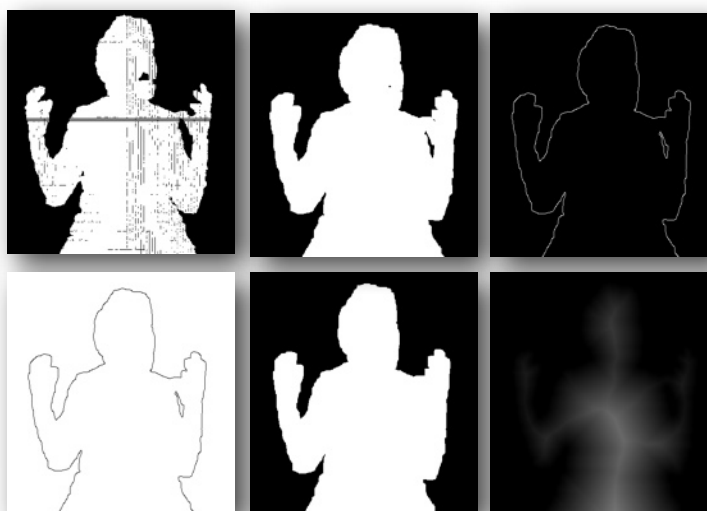
Figura 32a: Se observan 5 pasos: Dilatación, Canny, Inversión, Máscara binaria, Mapa de distancias
