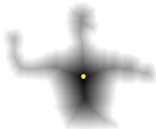
Figura 14: Estimación del mapa de distancias a partir de la imagen del sujeto segmentado del fondo.
