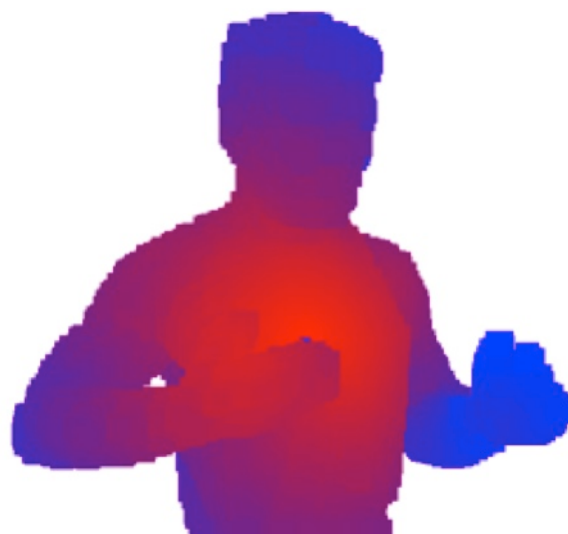
Figura 15: Estimación del mapa geodésico sin el uso de las restricciones de flujo óptico. El color rojo representa valores geodésicos bajos y azul, altos.
