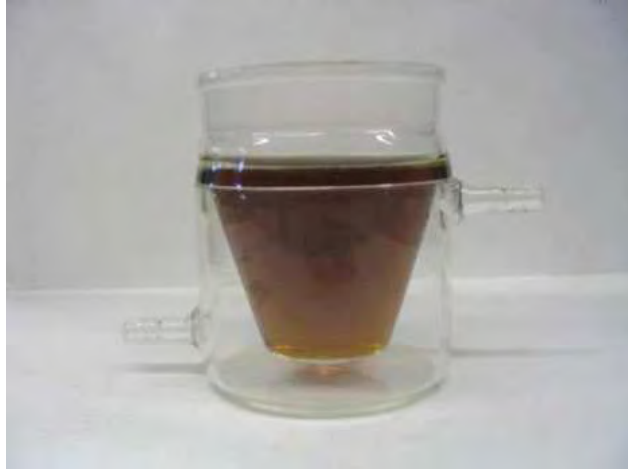
Figura 3.2. Celda electrolítica encamisada de 100 mL
