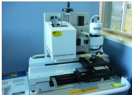
Figura 3-18: Imagen del microdurómetro utilizado en la caracterización de las propiedades mecánicas de los recubrimientos de Cr y NiW
