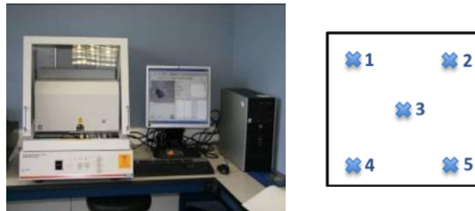
Figura 3-13: Equipo de fluorescencia de rayos X utilizado y puntos de medida del espesor y la composición en las muestras
