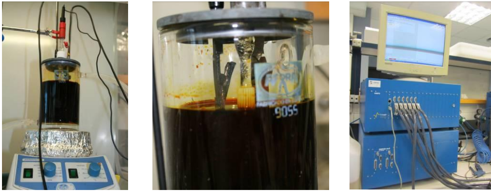
Figura 3-4: Celda electroquímica y potenciostato utilizados en la electrodeposición de cromo
