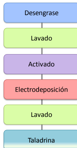
Figura 3-7: Esquema de la secuencia de proceso empleada en la electrodeposición de cromo a escala industrial
