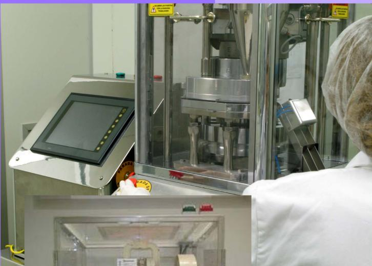
Imagen 1. Comprimidora rotatoria
