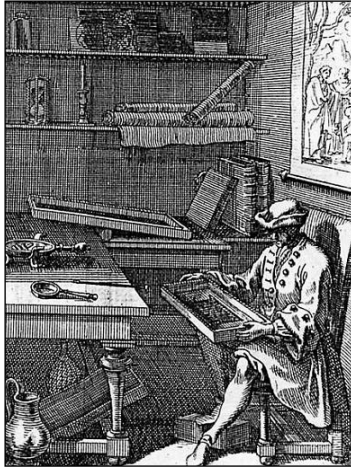
A. Bosse. Traité des manières de graver en taille douce sur l'airin. Par le moyen des eaux fortes et des vernix durs et mols. Paris: Gutenberg Reprint, 1979 (1645), Reedición de Ch.N.Cochin del 1745, Plancha 9. Demostración del aguafuerte aplicado en cubeta.
