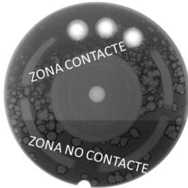
Figura 4.27. Imatge de raigs X de la geometria del vidre segellant en dispositius thick film sobre alúmina on s'aprecia diferent morfologia del vidre degut a la presència de zones amb falta de contacte.
