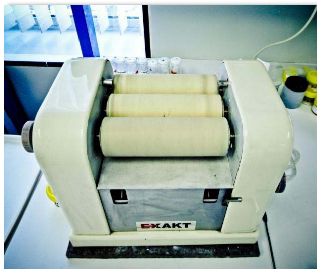
Figura 2.7. Molí de rodets tricilíndric.
