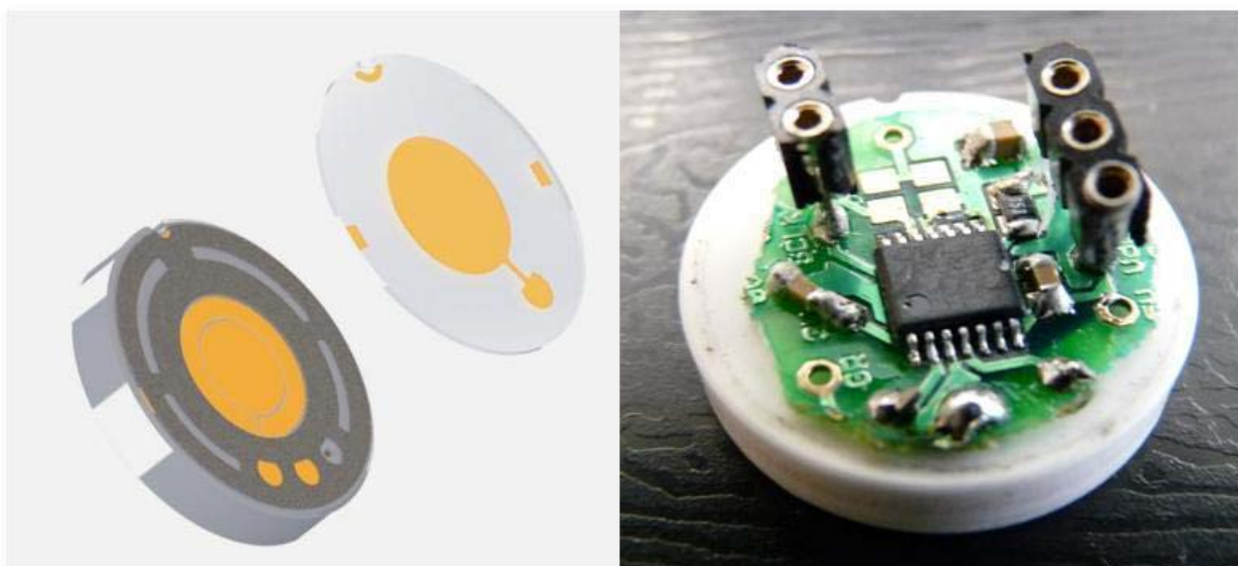
Figura 4.10. Esquerra: esquema de mòdul sensor de pressió ceràmic capacitiu fabricat en tecnologia thick film . Dreta: Imatge de l'electrònica de condicionament del senyal muntada en el dispositiu sensor.
