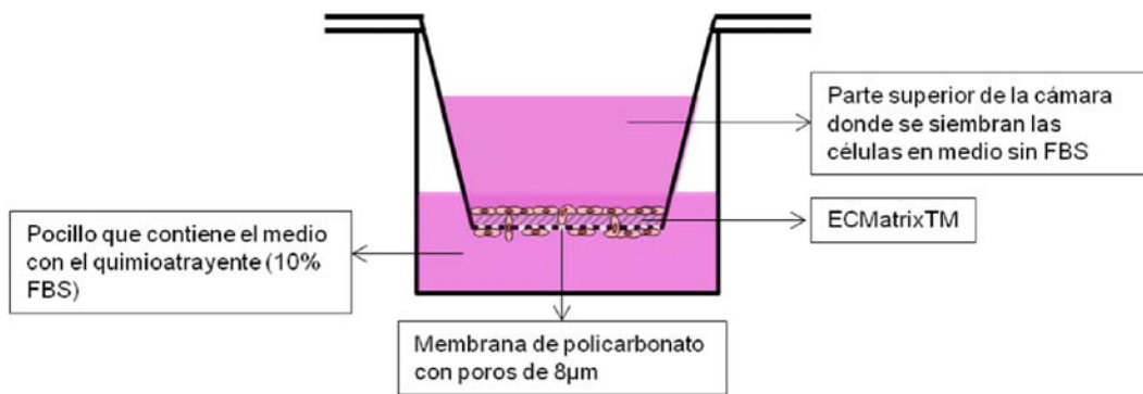
Figura 12. Diagrama representativo de una cámara de Boyden o Transwell para ensayo de invasión.
