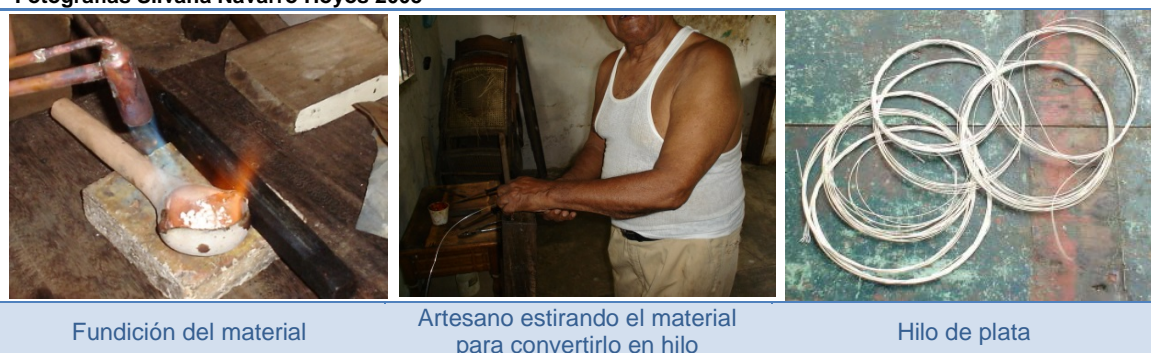
Cuadro 27. Imágenes del proceso productivo de la elaboración de hilo de plata. Fotografías Silvana Navarro Hoyos 2005
