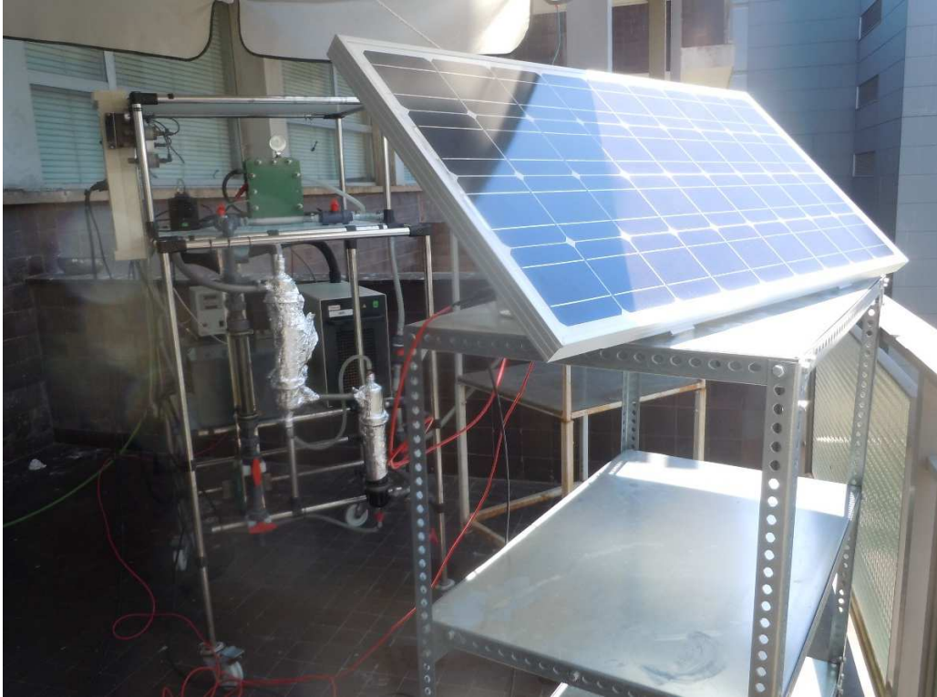
Figura 9. Planta pre-piloto autosuficiente en funcionamiento gracias a la aplicación directa de energía solar fotovoltaica.
