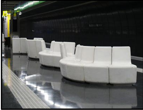
Figura 19.1. Asientos instalados en el andén de la estación de Roquetes . Estos asientos no fomentan adecuadamente la vigilancia natural, dado que al estar posicionados en forma de curva, dependiendo del asiento, no se tendrá visibilidad de gran parte de la estación.
