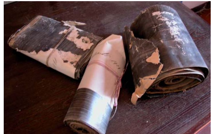
Figura 3. Bandas ahumadas enrolladas y bandas con fajas con descripción de un movimiento sísmico.
