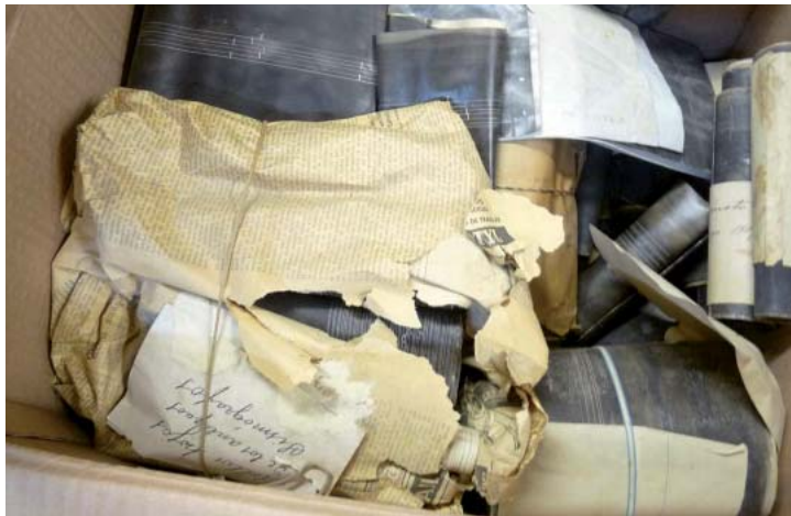
Figura 3. Bandas ahumadas enrolladas y bandas con fajas con descripción de un movimiento sísmico.
