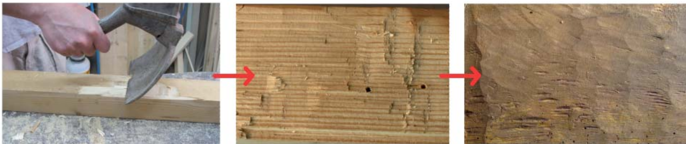
Figura 1. A l'esquerra, imatge que mostra com s'utilitza una aixa girada. Al centre, la marca que ha deixat aquesta eina a la fusta. A la dreta, la marca original d'una aixa girada al suport del frontal de Vilaseca (MEV 5).
