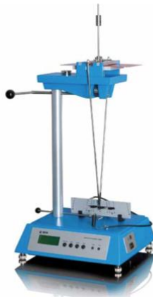
Figura 9. Medidor de dureza de BYK-Gardner con péndulo König (imagen extraída de www.Byk-Gardner.com , 20/12/13)
