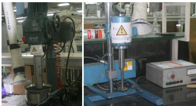
Figura 4. La imagen de la izquierda muestra un agitador tipo Vollrath y la de la derecha un agitador tipo cowless.
