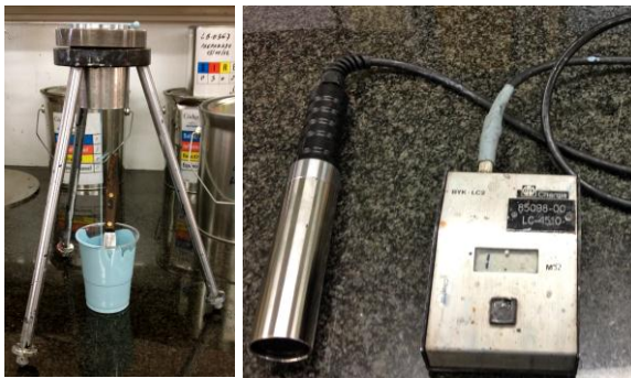
Figura 5. La imagen de la izquierda muestra una copa consistométrica FORD 4 y la de la derecha el instrumento de medición de conductividad BYK LC2
