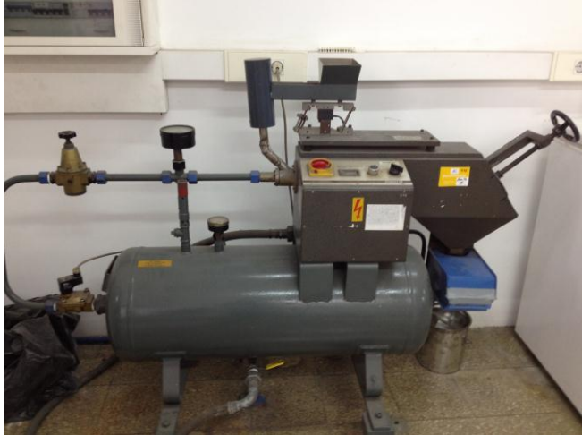
Figura 12. Máquina de ensayo de gravillonado
