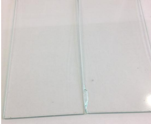
Figura 34. Resultados del vertido de barnices para el prototipo I almacenado a 23°C (izquierda) y a 45°C (derecha)
