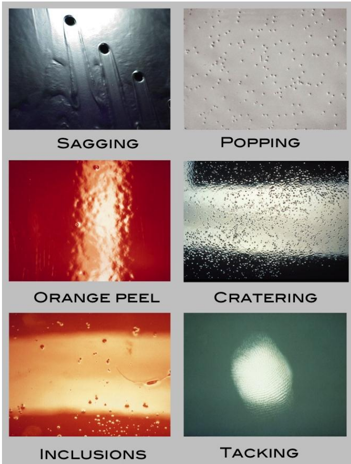
Figure 1. Clearcoat paint defects (image from Porta, E. Curso de Pintado de elementos plásticos. Documentación interna.)
