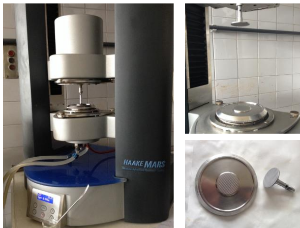
Figura 8. Reòmetre HAAKE-MARS i els sensors placa-placa
