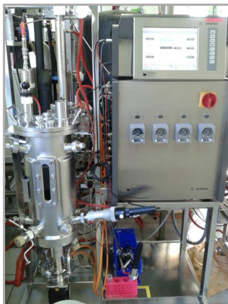
Figura 8. Bioreactor (Biostat C-DCU, Sartorius, Germany) usado para la fermentación optimizada de GABA.
