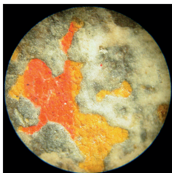
Fig. 17. Detall, ampliat a 60 augments, de la línia vermella realitzada amb una pintura semitransparent i aplicada per sobre (o formant-ne part) de la capa de colradura groga. Imatge obtinguda amb un microscopi portàtil (objectiu PEAK 10 X / 6 - NA 0,15) / Detalle, ampliado a 60 aumentos, de la línea roja realizada con una pintura semitransparente y aplicada por encima (o formando parte de ella) de la capa de corladura amarilla. Imagen obtenida con un microscopio portátil (objetivo PEAK 10 X / 6 - NA 0,15).
