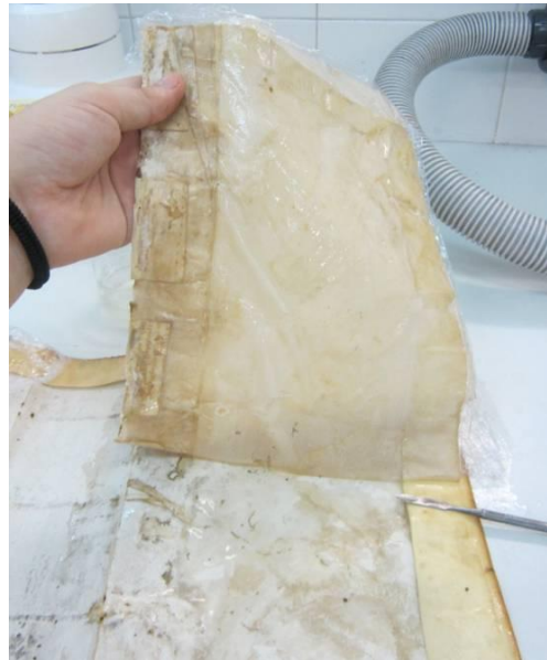
Desenganxat de les guardes de la tapa
