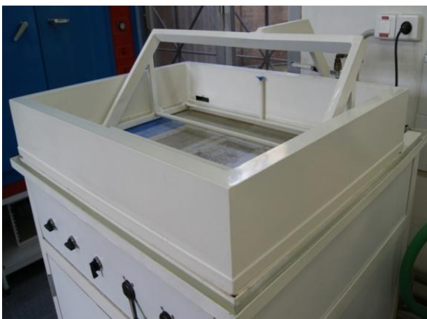
Reintegració amb la màquina reintegradora
