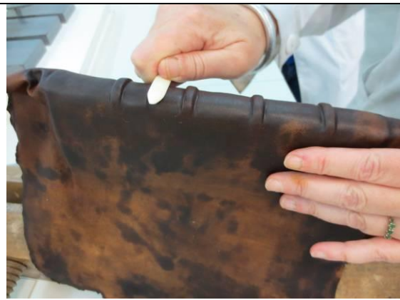
Procés d'enquadernació. Amb la plegadora s'ajuda la pell a adaptar-se correctament als nervis del llibre.
