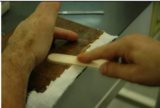
Es passa la plegadora per a garantir una bona adhesió de la tela
