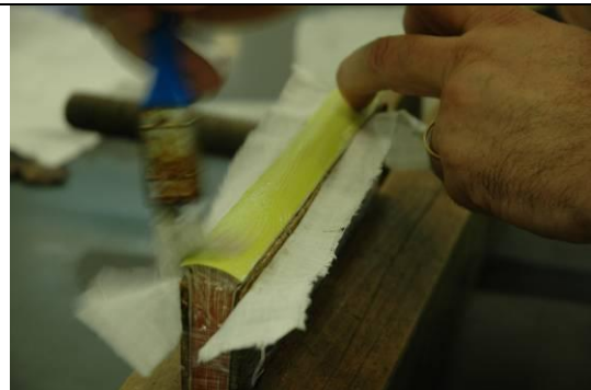
Col·locació d'una cartolina al llom adherida només per les vores. S'aplica cola per a poder adherir les teles
